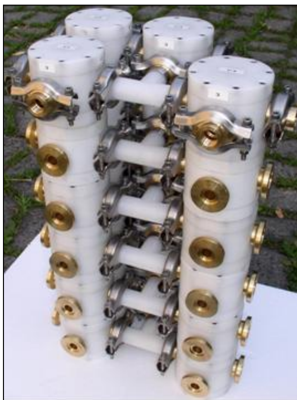
FIGURA 2 - ESEMPIO ISOLE DI VALVOLE PER LA GESTIONE DI OTTO COLORI SU MACCHINA DA STAMPA
